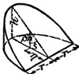
4. **Pyramide und Kegel:**  $S$  liegt in der Schwerachse (vgl. 12 auf S. 193) um ein Viertel der Höhe von der Grundfläche entfernt.
