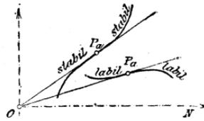
brauchbaren Teil — Regler stabil — von dem unbrauchbaren — Regler labil. Ist  $OP_a$  eine Wendetangente, so kann der Regler ganz stabil oder ganz labil sein (Abb. 462).
